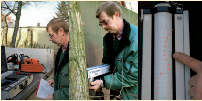
Der Baumkontrolleur Axel Kuschke bestätigt mit dieser Resistograph-Untersuchung (rechts) die Ergebnisse seiner Prüfung.
