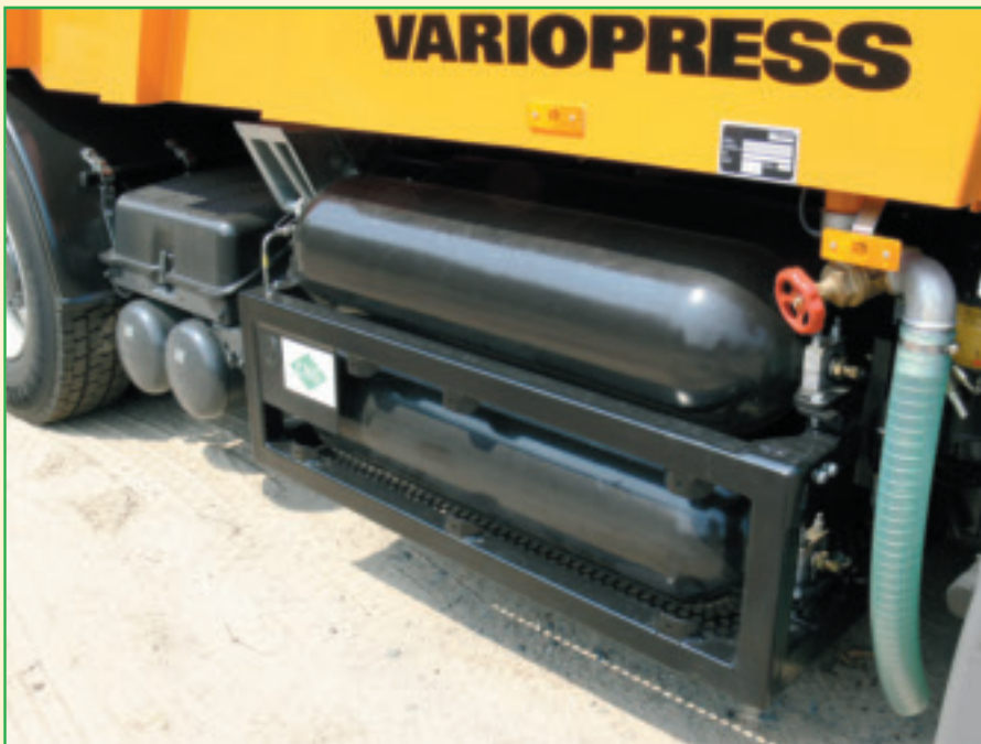
In einem Stahlkäfig gesichert: Die doppelwandigen Erdgas-Tanks des Eonic.
