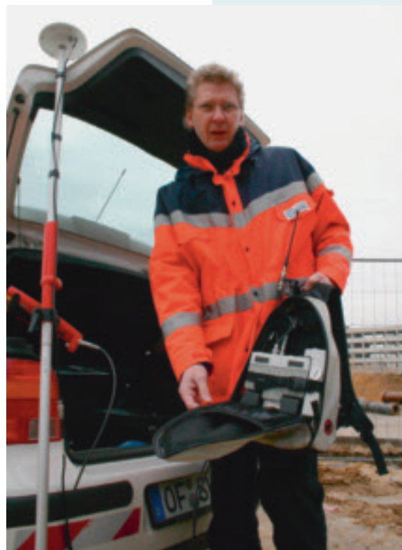
Antenne, Lotstock, Handgerät und Rechner im Rucksack: Die Ausrüstung zum genauen Kartografieren mit Satellitenunterstützung ist mit wenigen Handgriffen einsatzbereit.
