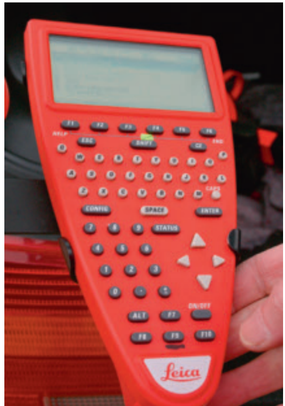
Die kompakte GPS-Einheit ist über eine spezielle Antenne an der Spitze des Lotstocks mit mehreren Satelliten im Orbit verbunden. Je mehr Satelliten erreicht werden, desto genauer ist das Mess-Ergebnis.
