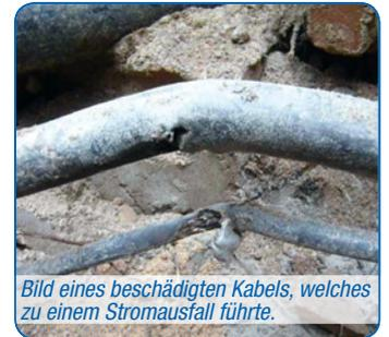
*Bild eines beschädigten Kabels, welches zu einem Stromausfall führte.*
