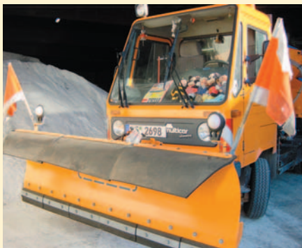
Für den Wintereinsatz gerüstet: Der Mulicar M 26: Links mit Schneepflug und rechts mit der dem rotierenden Streusalzverteiler. Im Hintergrund der befeuchtete Streusalzvorrat.
