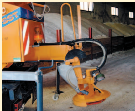
Für den Wintereinsatz gerüstet: Der Mulicar M 26: Links mit Schneepflug und rechts mit der dem rotierenden Streusalzverteiler. Im Hintergrund der befeuchtete Streusalzvorrat.
