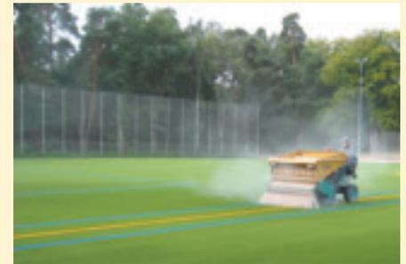
lag: Eine gerade Faser, die von weitem kaum noch von echtem Rasen zu unterscheiden ist. Diese moderne Monofilamentfaser des „Tepichs“ ist einem Grashalm nachempfunden, leicht gebogen mit einer Art Mittelrippe. Dadurch soll sich die Faser nach Betreten auch langfristig wieder aufrichten. Der Platz im Sportpark ist neben dem gelb eingezeichneten
