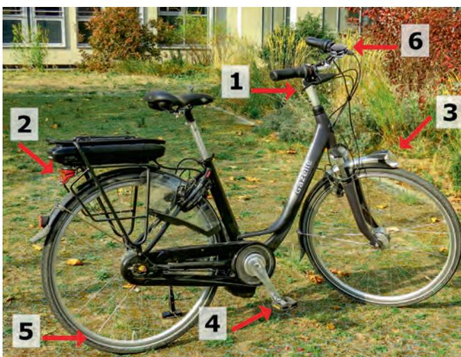
Abb. 1: Das verkehrssichere Fahrrad: **1** Vorder- und Hinterradbremse, **2** Rücklicht mit rotem Reflektor, **3** Vorderlicht mit weißem Reflektor, **4** Pedale mit je zwei Katzenaugen, **5** reflektierende Reifen, **6** Klingel.
